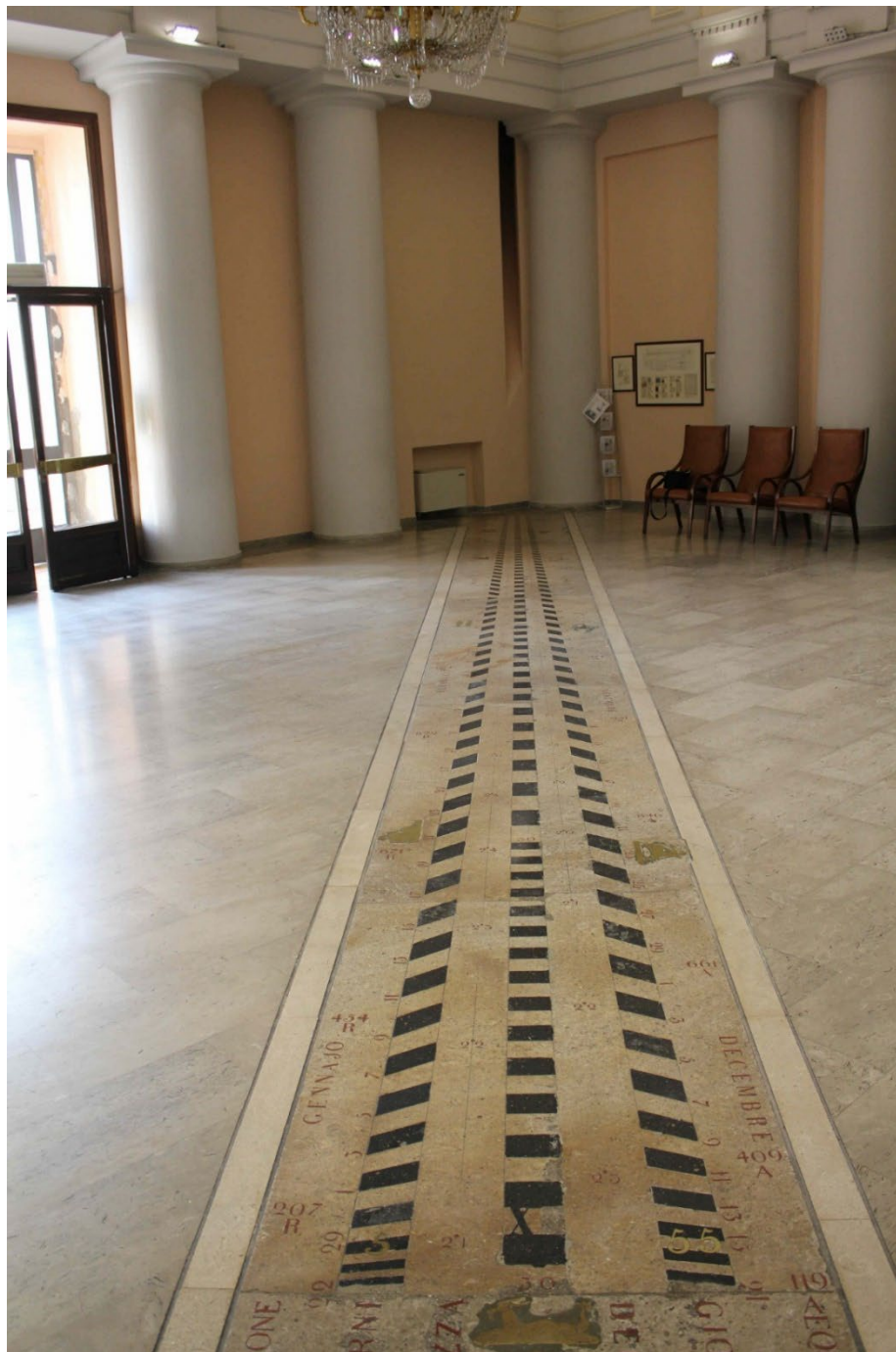
Figura 3 – La Linea Meridiana fotografata il giorno 9 gennaio 2019 alle ore 12:12:24. Il passaggio al meridiano era già avvenuto alle 12:11:54. Il capitello ha impedito del tutto il formarsi dell'immagine solare sulla LM
