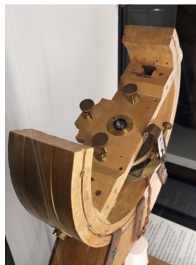
Foto 5-6- Strumenti per disegnare meridiane, in particolare sulla destra un Proiettore di meridiane in legno realizzato nel 1946 dall'Ingegnere Giuseppe Flora.
