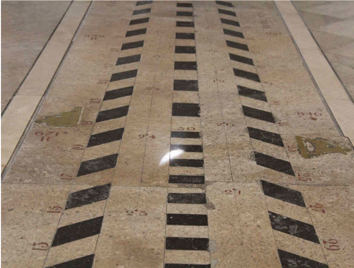
Figura 4 - La Linea Meridiana fotografata il giorno 11 gennaio 2019 alle ore 12:13:22. Il passaggio al meridiano era già avvenuto alle 12:12:43. Il capitello ha impedito quasi del tutto il formarsi dell'immagine solare sulla LM.
