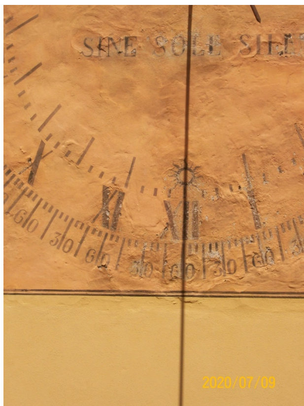
Figura 4 – Verifiche del corretto allineamento del supporto dello stilo polare mediante il passaggio della linea d'ombra sul piccolo Sole.
